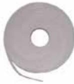
Dieses Band dient als Abgrenzung und Abdichtung des Flüssigphotopolymers während der Verarbeitung in der Maschine. D.h. es wird am Rand des Negativs auf die Schutzfolie geklebt und unterstützt zusätzlich noch eine gleichmäßige Textplattenhöhe.
